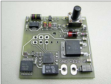
Bild 10: Ansicht der fertig bestückte Platine; jetzt nur nicht mehr die Bauteile bewegen!
